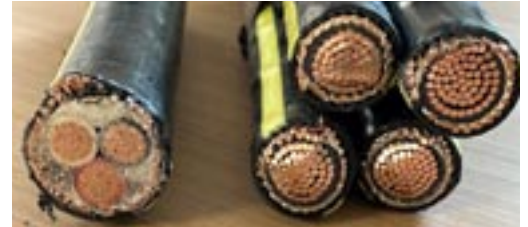
Eindrückliches Beispiel einer Netzverstärkung von bisher 95 mm 2 (links) auf neu 240 mm 2 (rechts)
